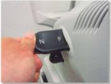
Puxe para dentro/fora o seletor de filtro RF
